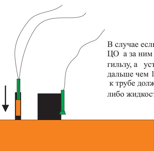
В случае если отверстие на котле одно, то сначала опускается датчик ЦО а за ним «термик». Также один из вариантов датчик ЦО в погружную гильзу, а установка «термика» на подающей трубе **отопления**, но не дальше чем 10 см от выхода трубы из котла, при этом прижатие его к трубе должно выполняться металлическим хомутом. Добавление, каких либо жидкостей в отверстие, куда опускаются датчики, **запрещено!**
